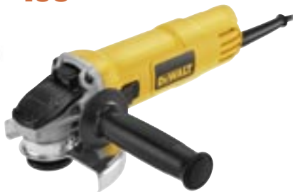
Cód. 144561 AMOLADORA CON CABLE STANLEY Amoladora angular DWE4157-QS Ø 125 mm, 900 W, 11.800 rpm, rosca M14. Incluye: guarda protectora, empuñadura lateral multiposición, tuerca interna y externa, llave. 109€
